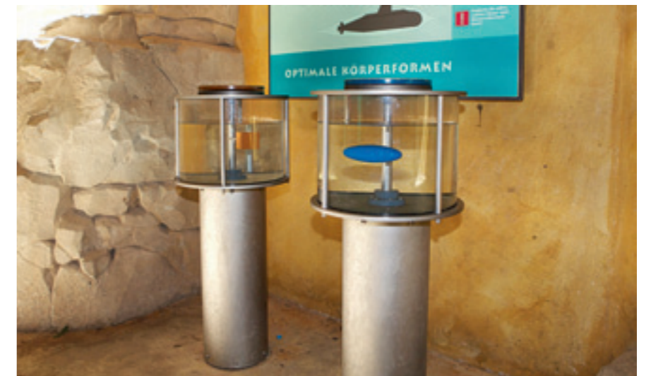
Um einen Würfel durch Wasser zu bewegen, muss man mehr Kraft aufwenden als bei einem stromlinienförmigen Objekt. So versteht man, warum Robben nicht in Würfelform durchs Wasser schnellen.
