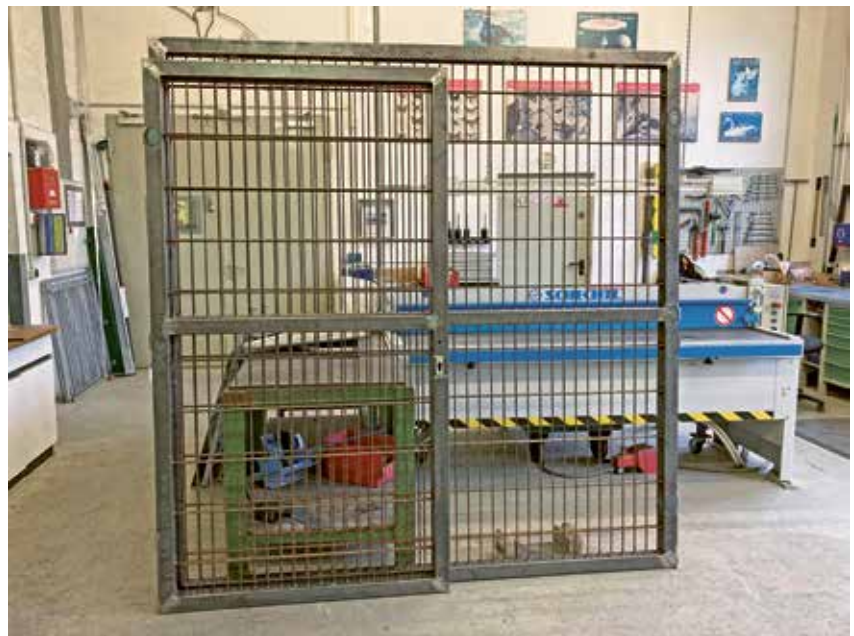
Bereit zum Verzinken – eines der neuen Tore für die Bongo-Anlage in der zoeieigenen Schlosserei.
